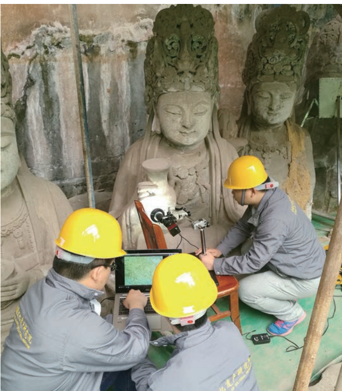
大足石刻卧佛弟子像岩石表层风化程度(微观结构)探测评估
